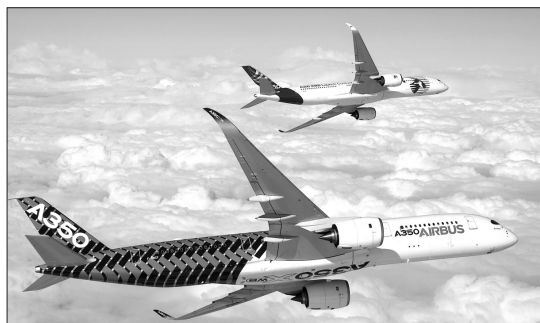
Lancé en 2013, l'Airbus A350 est aujourd'hui l'avion de ligne qui fait le plus appel aux matériaux composites, lesquels représentent 53 % de sa structure. (Crédit photo: Airbus -S.Ramadier)
