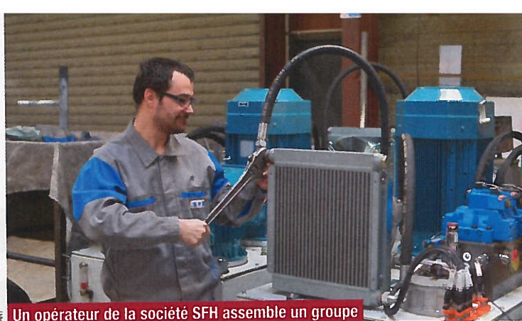
Un opérateur de la société SFH assemble un groupe hydraulique pour une machine de traitement de copeaux type PM3.
